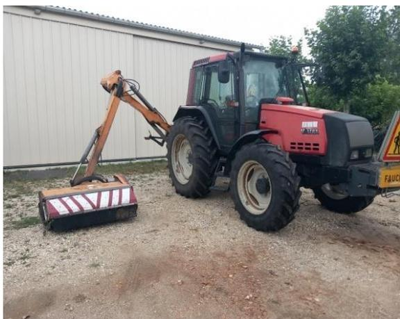
Le tracteur et l'épaveuse de la commune ont une vingtaine d'années... Ce matériel indispensable est fortement utilisé. Il a lui aussi besoin d'un entretien régulier. Le tracteur communal a dû être arrêté quelques jours pour de grosses réparations au niveau de l'arbre de prise de force. L'épaveuse, utilisée pour l'entretien des fossés, a fait l'objet d'importantes réparations afin d'assurer le fauchage de nos routes.
