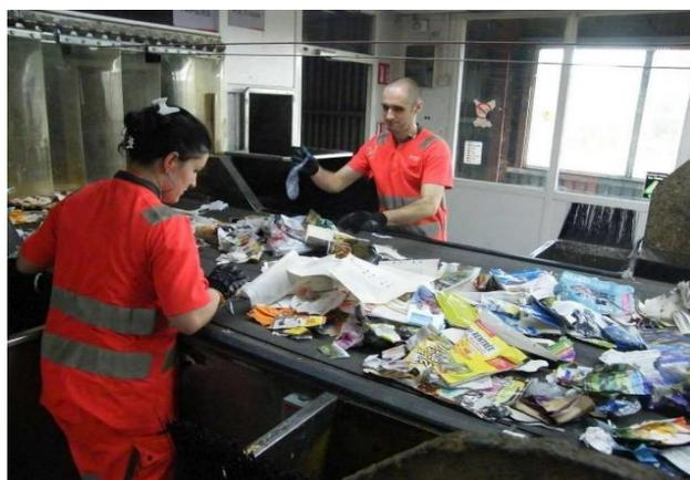
Les poubelles jaunes sont déposées à Saint-Denis-de-Pile sur la plateforme Trigironde et triées, en partie par des automates et aussi par des humains : métal, plastiques, cartons... afin d'être recyclés.
